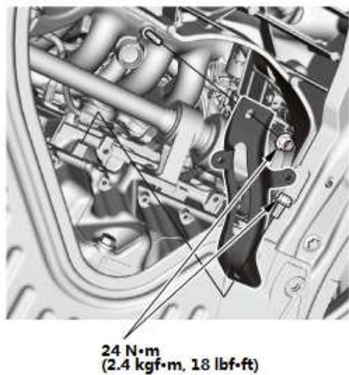
6. 进气歧管总成 - 拆卸
