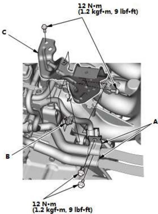
5. 进气歧管托架 - 拆卸
